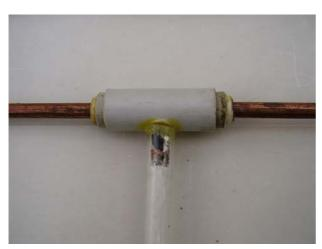
Il tubo di plastica, che ora costituisce la parte centrale del dipolo, è stato isolato dalle intemperie inserendovi a forza, all'interno dei due tubetti terminali da 10 mm, più due pezzettini di tubetto di plastica flessibile, dello stesso tipo usato per isolare dal boom gli elementi parassiti, del diametro interno di 6 mm..
