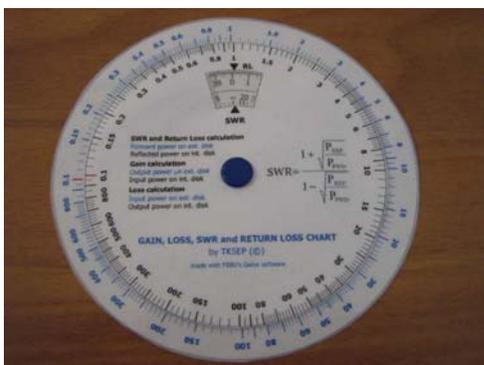
Lo strumento è un regolo progettato da [Patrick TKSEP](#) e da lui disegnato con il software Galva. Consente di calcolare rapidamente e con sufficiente precisione diverse grandezze utilizzate quando si lavora con i circuiti a RF o con le antenne. Sulla parte esterna presenta due scale logaritmiche per la potenza, con un range totale di 40dB da 0.1 a 1000 Watt.
