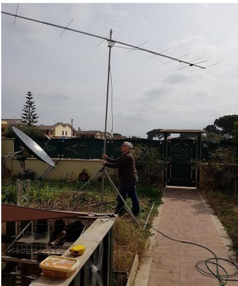
Il passaggio successivo è stato quello di vedere se girando l'antenna il ROS poteva variare: NO, era stabile. Ottimo! Ora ci rimaneva solo di ascoltare alcuni beacon e forse qualche stazione che era in radio, un IS0 ,un IT9, stando di fronte al mare ce li aspettavamo, anche se trasmettevamo con 5 watt.
