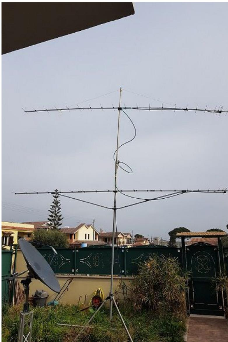
Montiamo le due antenne e mettiamo il cavo: ad un primo controllo avevamo un ROS pazzesco.. 1:4 (quattro).
