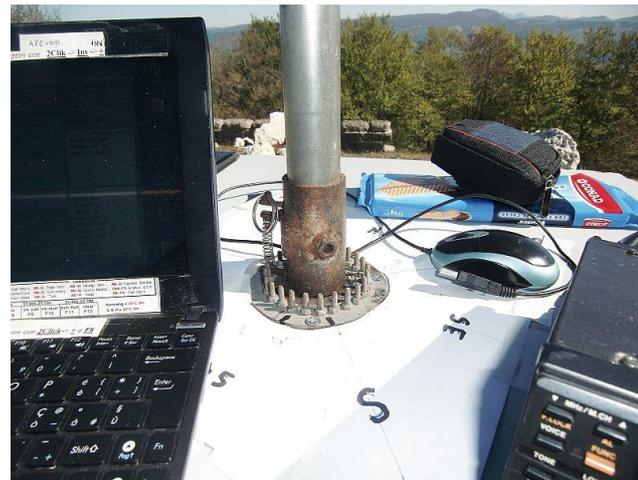
*Fra queste foto, l'ultima, mostra l'interessante soluzione adottata da Aldo IK0RWW per tenere ferma l'antenna dall'azione disturbatrice del vento. Il tavolo porta un foro centrale, attraverso il quale passa il mast dell'antenna. Un settore con tanti piolini ed un nottolino che vi si frappone, sotto l'azione di una molla, tiene fermo il tutto. Il palo, ovviamente è controventato altrimenti ... addio tavolino e .... apparato !*
