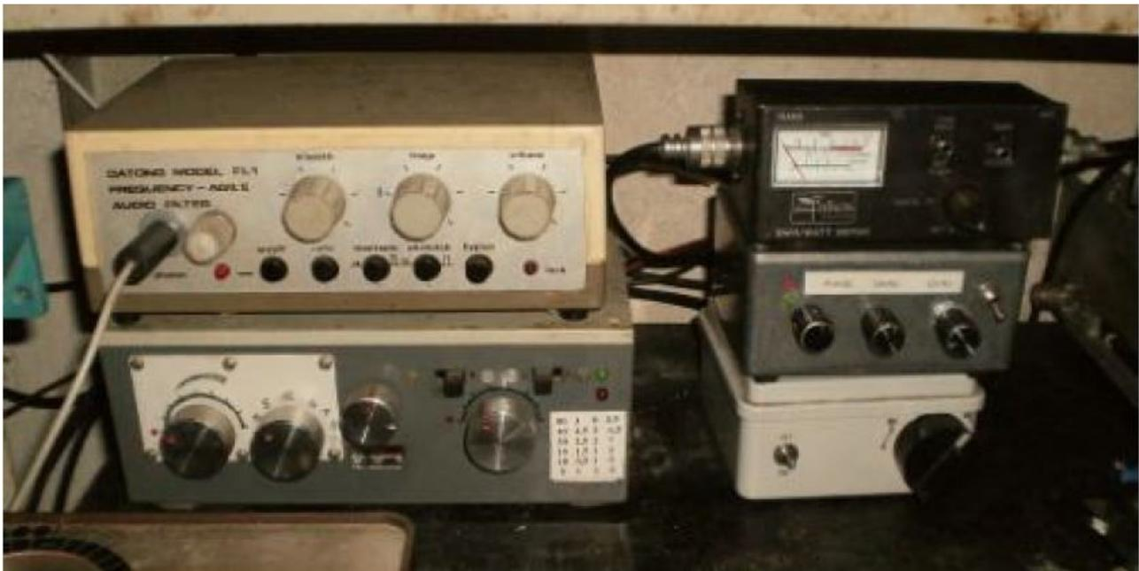
Oggi però poteva essere risolutivo per stringere la banda passante audio a poco più di 200 Hertz e posizionare il filtro sopra il segnale RTTY (170 Hertz) in modo che tutto il resto dei segnali non arrivassero al decodificatore.
