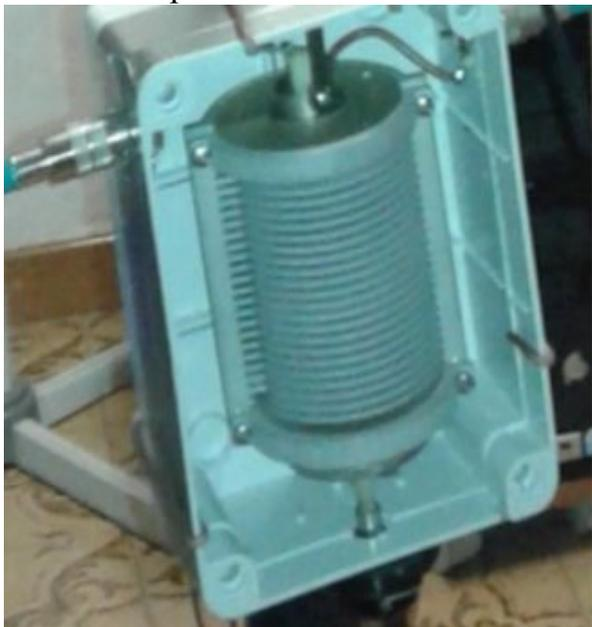
Con mia soddisfazione accordava benissimo sui 40 e 80 metri ma all'atto di andare in trasmissione non potevo trasmettere con più di dieci Watt senza che il condensatore si mettesse a sfiammare problema dovuto alle lamelle troppo ravvicinate.
