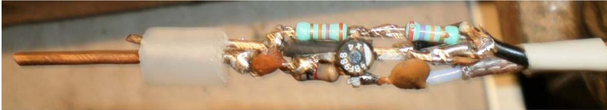
L'assorbimento è di 8 mA @ 12 volt; il dispositivo non introduce alcun guadagno, anzi, ma fornisce praticamente la stessa ampiezza del segnale all'ingresso ma con una impedenza di uscita bassa ed adatta per essere applicata al nostro frequenzimetro e soprattutto senza rappresentare alcun tipo di carico verso qualsiasi circuito sotto esame.
