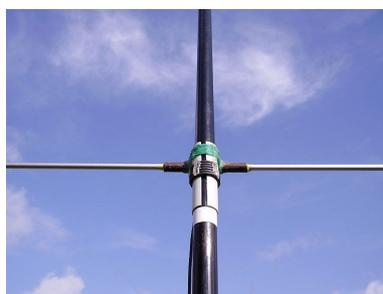
I tubetti orizzontali di supporto, dei quali il centrale è ovviamente segato a metà per il collegamento al cavo coassiale, sono legati e successivamente incollati ad un tubo di plastica per impianti elettrici, del diametro di 20 mm, segato a metà longitudinalmente per poter scorrere lungo la conicità della canna da pesca.
