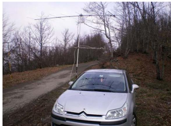
La soluzione è validissima e non ha creato problemi. Quello che è mancato, invece, è stato un sistema di bloccaggio, per mantenere le antenne nella direzione voluta e resistere al vento.
