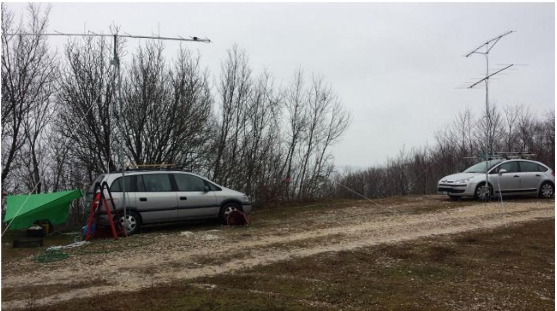
Per di più, la scelta davvero infelice è stata installare la seconda antenna dei 144 Mhz ( usavamo per la prima volta lo Splitter in 144 MHz) sotto la 21 Tonna dei 432 Mhz, sul palo gestito dall'altra macchina. Potete immaginare cosa un centinaio di watt emessi sotto quella povera Yagi per i 432 Mhz causasse a quei poveracci dell'altra macchina.
