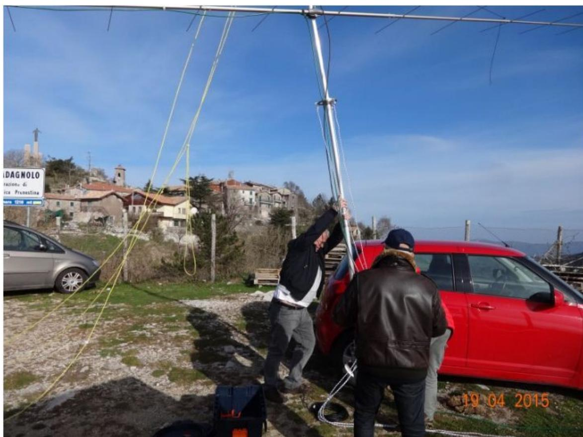
Queste antenne, costituite dalla 16 Elementi I0JXX per i 144 MHz e la 21 Elementi Tonnà per i 432 Mhz, ingegnosamente motorizzate dall'RPV, con gittate sostenute rispettivamente da 14,49 dBd e 15,45 dBd, sono state accuratamente poste "in punteria" verso Nord – Nord/Est.
