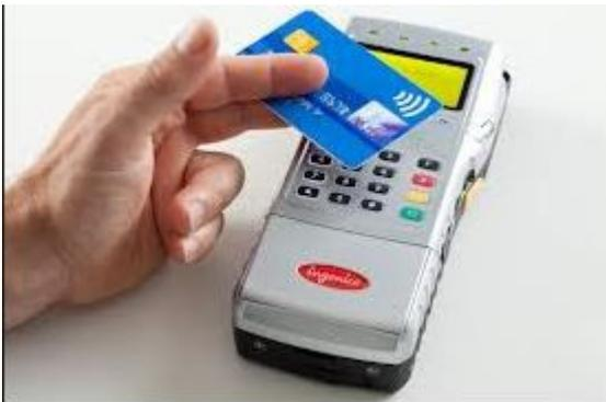
I tag NFC sono etichette di vari materiali in cui è inglobato un dispositivo radio in miniatura composto da una bobina (un circuito stampato in una spirale piatta) e un microchip.
