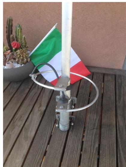
Quarta fase lo stilo di base che supporta tutta la verticale che misura 1350mm, l'ho dovuto accorciare di 20mm, portandolo a 1150mm, perché piegato alla base e cercare di riportarlo in linea non è stato possibile data la scarsa qualità dell'alluminio poco malleabile.
