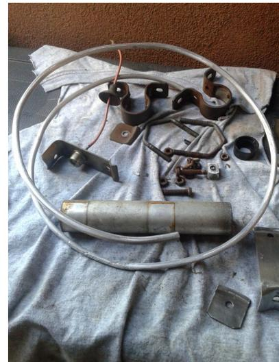
Seconda fase pulitura con carta abrasiva molto fine per eliminare l'ossido del tempo, polvere e ruggine
