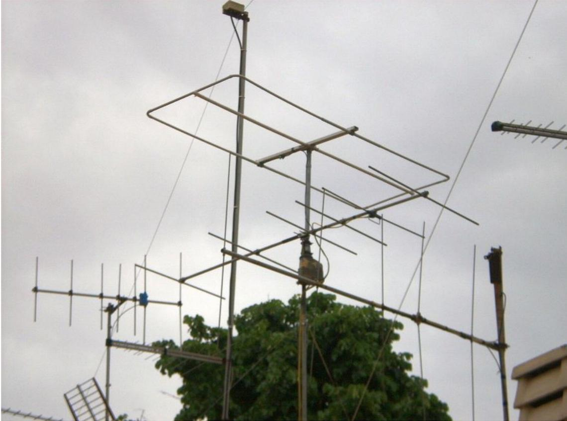
notavo che la Yagi dei 144 Mhz di allora (era una quattro elementi oggi sostituita con una “sei”) sembrava assai poco direzionale.
