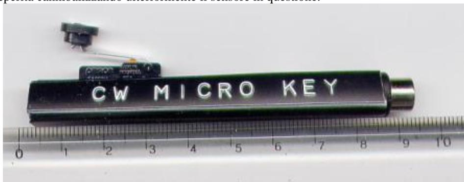
Sei o sette cm di filo flessibile unipolare, anche questo proveniente da medesima fonte, sono stati usati per collegare il microswitch allo spinotto. Assemblato il tutto come in foto lo si inserisce nel pezzetto di dorso di cui si è parlato ed il tasto extra.mini è bello e pronto da collegare al nostro RTX QRP per il prossimo contest SOTA in CW.
