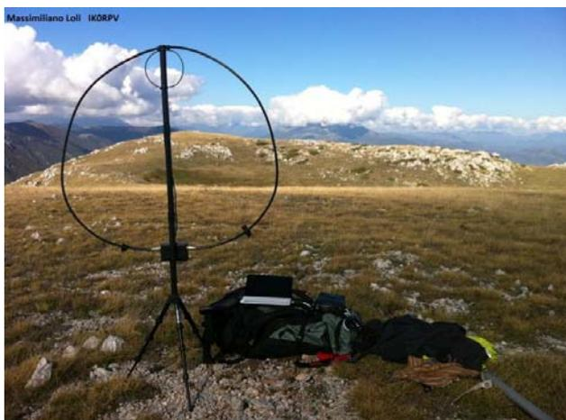
Considerando l'intenzione di attivare le tre cime in giornata, quindi montare/smontare la stazione per tre volte, ho pensato di portarmi due antenne: il loop magnetico ed il dipolo rigido per i 15 mt. Il loop in particolare mi avrebbe consentito di montarlo rapidamente e spaziare sulle bande dai 40 ai 10 mt. Alla fine però, l'ho usato solo per il Monte Terriccio: ricevevo ma non mi sentivano ed alla fine ho fatto solo due QSO in 20 metri.
